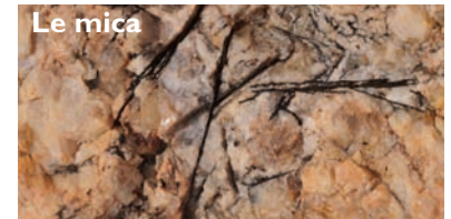
Q= Quartz ; M= Mica noir ; F k = Feldspath potassique ; F pl = feldspath plagioclase
