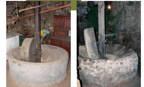
Rosazia, moulin à farine dit "moulin à châtaignes" construit peu avant 1909 ; Ambiegna et Arro, deux moulins à huile à manège situés dans l'étage de soubassement de maisons.
