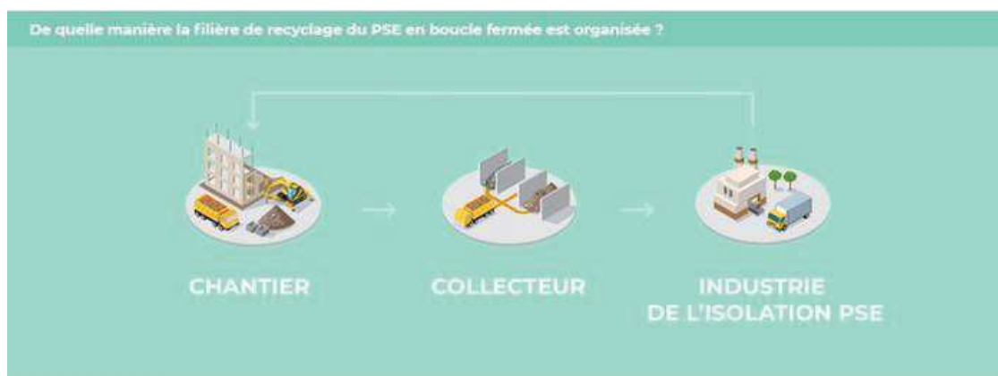
Figure 45: De quelle manière la filière de recyclage du PSE en boucle fermée est organisée ? (source : www.democles.org)
