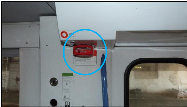
Poignée de signal d'alarme (AMG 800)
