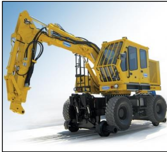
Exemple de pelle rail route (matériel non CFC)
