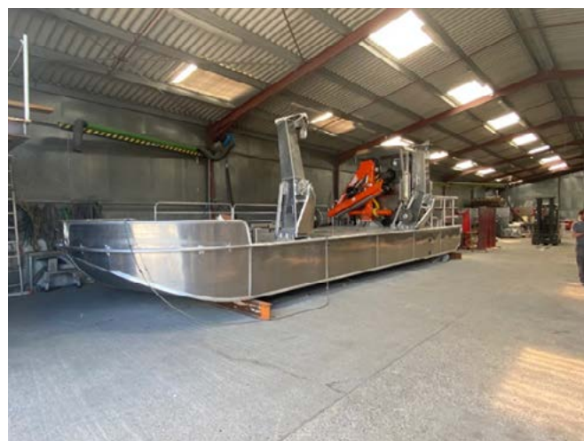
FEAMP : construction en cours d'une barge ostréicole (EARL « île de Diana »)
