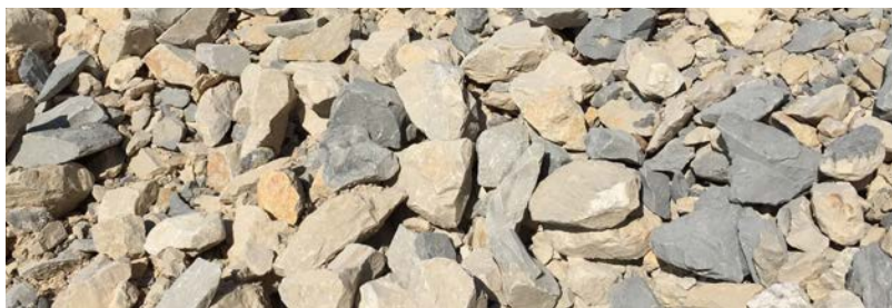
Remblai du chantier aval concassé
