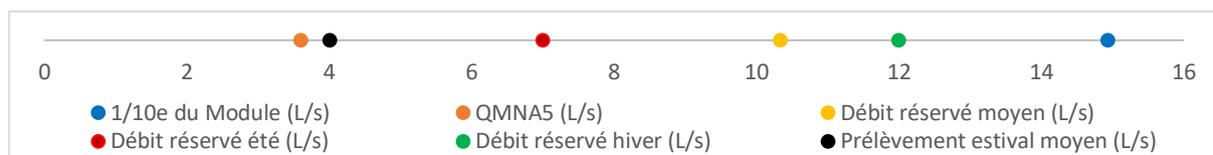
Figure 80 : Répartition du 10<sup>e</sup> du module, du QMNA5, du débit réservé et du prélèvement estival moyen pour la prise de la Melaghja
