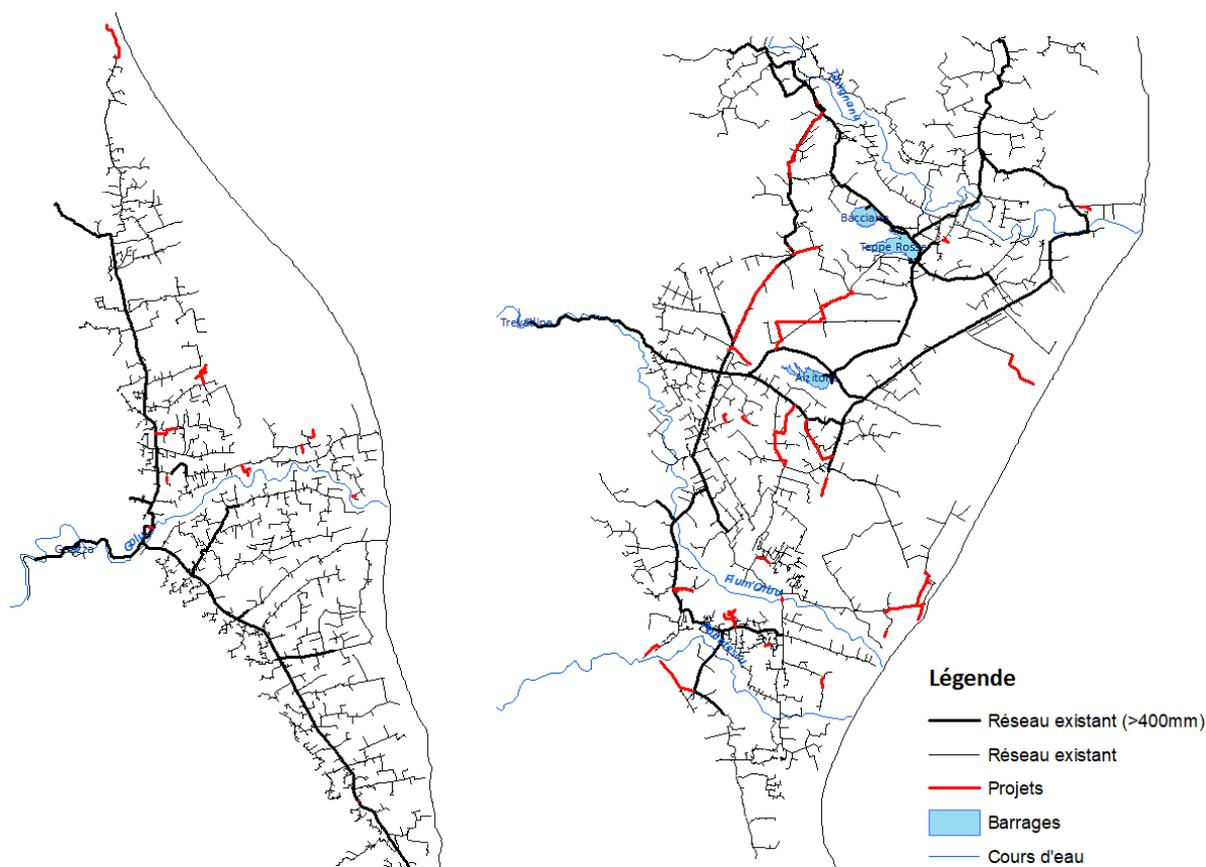
Figure 130 : Remplacement de canalisations vétustes en Plaine Orientale Nord et Sud
