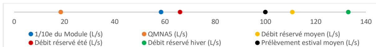
**Figure 60 : Répartition du 10<sup>e</sup> du module, du QMNA5, du débit réservé et du prélèvement estival moyen pour le barrage de l'Ortolu**
