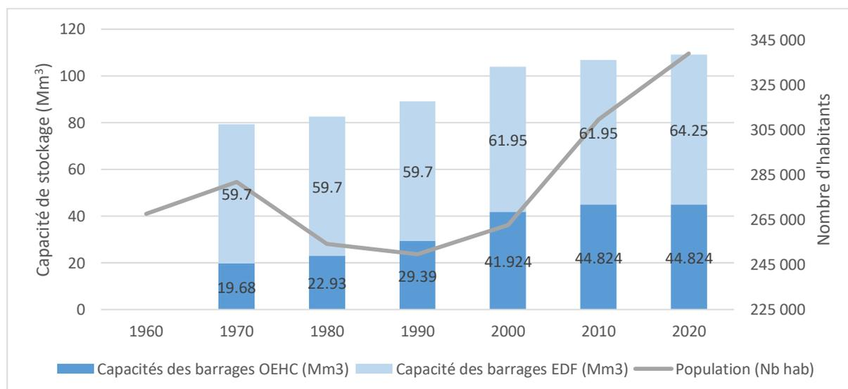
Figure 94 : Evolution de la population et de la capacité de stockage des barrages OEHC et EDF
