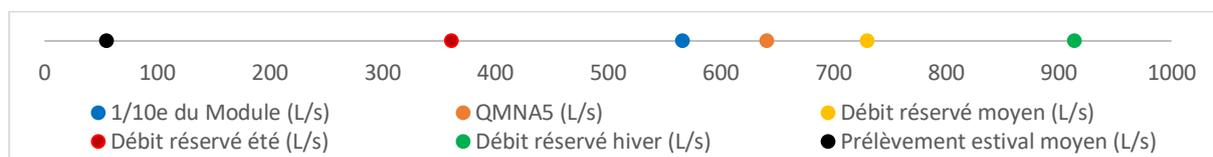
**Figure 68 : Répartition du 10<sup>e</sup> du module, du QMNA5, du débit réservé et du prélèvement estival moyen pour la prise de Sartè (Rizzanese)**
