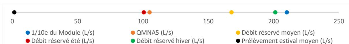
**Figure 72 : Répartition du 10<sup>e</sup> du module, du QMNA5, du débit réservé et du prélèvement estival moyen pour la prise de la Sulinzara**
