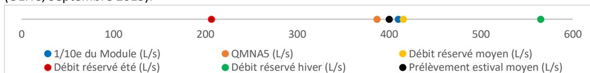
Figure 75 : Répartition du 10<sup>e</sup> du module, du QMNA5, du débit réservé et du prélèvement estival moyen pour la prise de Trevadine (Fium'Orbu)
