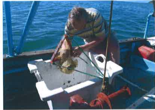
Remontée à la main et manœuvrée depuis une petite embarcation, cette drague permet de travailler sur les petits fonds (3 à 20 m)
