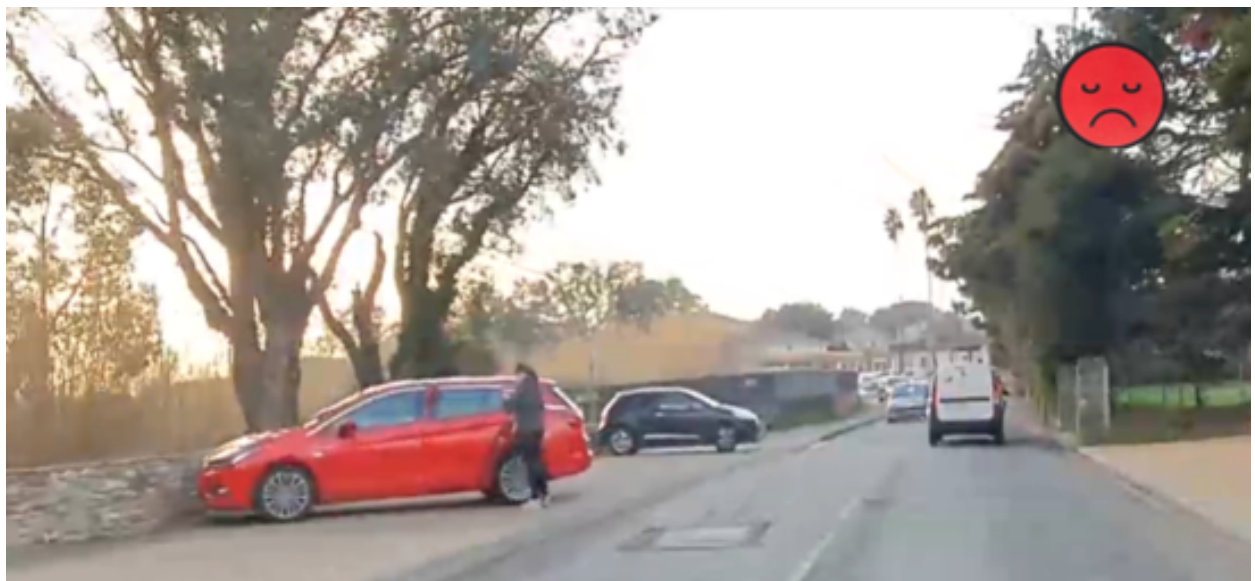
Parking sous dimensionné, rupture du cheminement piéton
