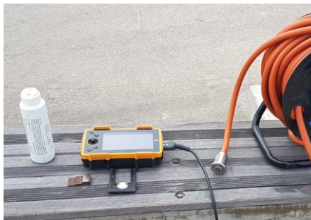
Phase de calibration avec cale étalon de 10 mm
